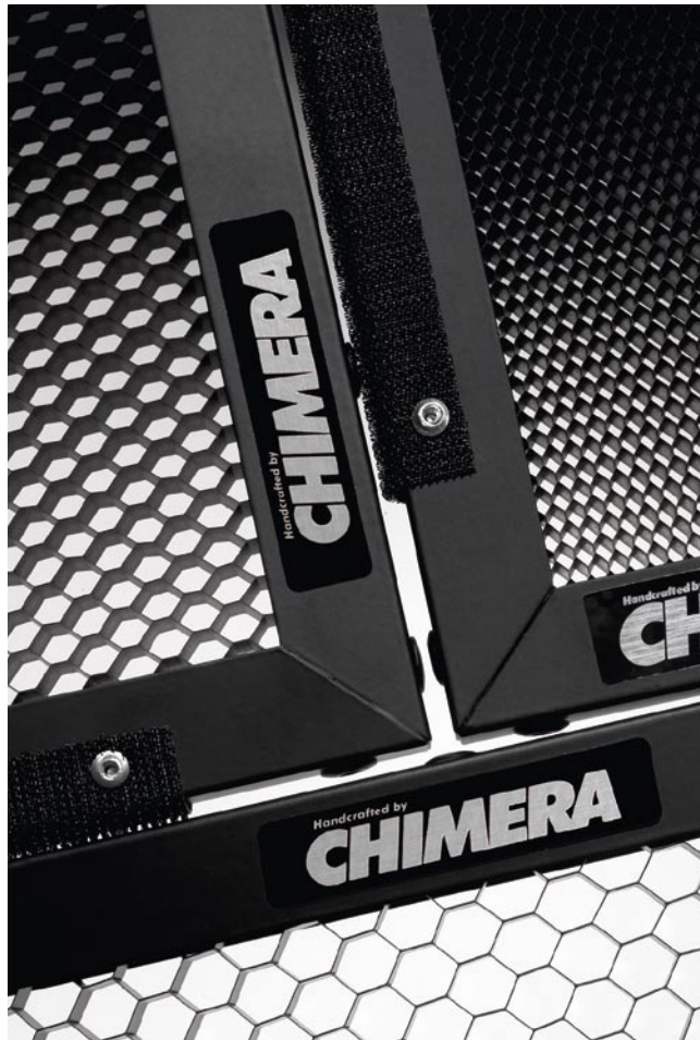
Wabenfilter werden direkt über der Lichtquelle befestigt. Licht, das durch Wabenfilter fällt, ist stärker gerichtet. Die LD-Kante ist klar gezeichnet, die Schatten sind dunkel. (mit freundlicher Genehmigung von Chimera)
